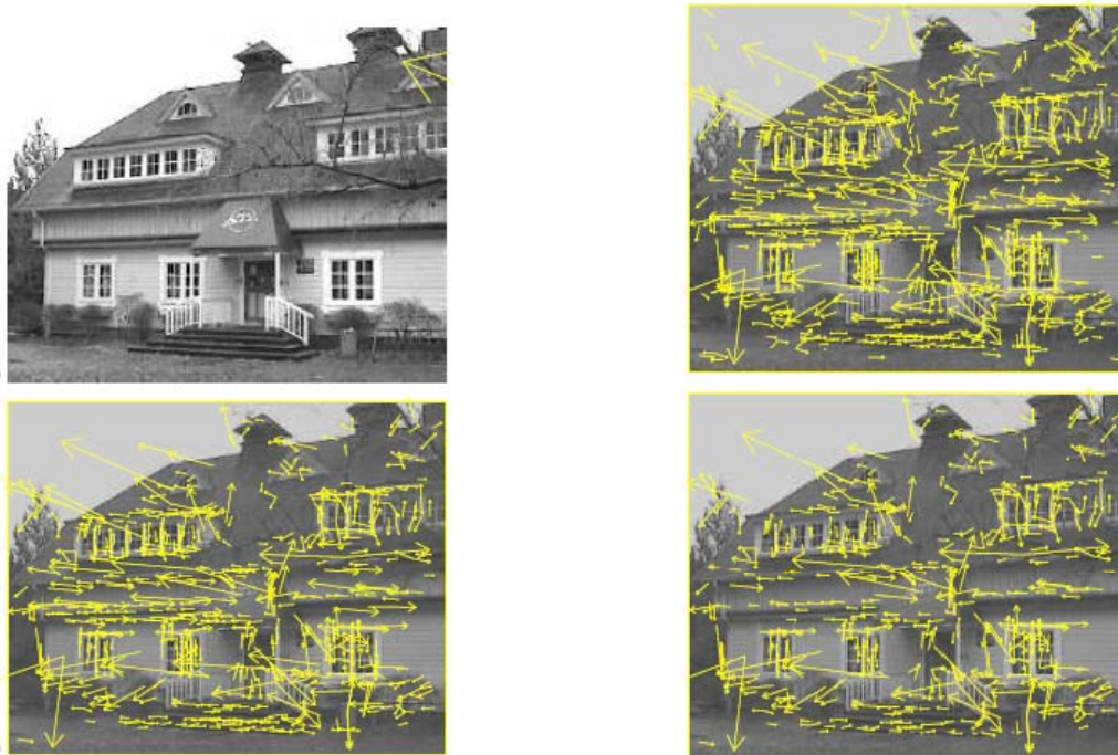
Figura 77. Estas figuras representan las etapas en la detección de puntos característicos. La imagen superior izquierda de 233x189 píxeles es la imagen original. La imagen superior derecha representa la localización de 812 puntos característicos de los máximos y mínimos de la diferencia de funciones gaussianas. Los puntos característicos se muestran como vectores indicando escala, orientación y emplazamiento. La imagen inferior izquierda muestra el proceso después de aplicar un umbral de contraste mínimo permaneciendo 729 puntos característicos. Finalmente tras aplicar un umbral de radio de curvatura quedan 536 puntos característicos. Adaptada de David G. Lowe [13].
